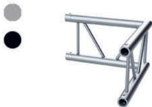
Esquina truss paralelo. 2 vías. 90°. 300mm. Tubo principal: 50x2mm. Tubo secundario: 16x2mm. Plateado o negro. SERIE F
