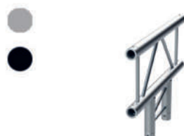
Esquina truss paralelo en T. 3 vías. 300mm. Tubo principal: 50x2mm. Tubo secundario: 16x2mm. Plateado o negro. SERIE F
