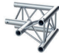
Esquina truss triangular. 2 vías. 90°. 250mm. Tubo princ: 50x2mm. Tubo sec: 13x1,5mm. Plata o negro. SERIE F
