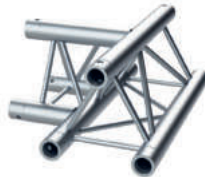
Esquina truss triangular en T. 3 vías. 250mm. Tubo principal 50x2mm. Tubo secundario 13x1,5mm. Plata o negro. SERIE F
