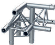
Esquina truss triangular. 3 vías. 90°. 250mm. Tubo princ: 50x2mm. Tubo sec: 13x1,5mm. Plata o negro. SERIE F
