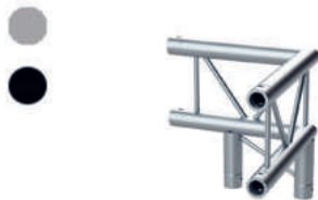
Esquina truss paralelo. 3 vías. 90°. 250mm. Tubo princ: 50x2mm. Tubo sec: 13x1,5mm. Plateado o negro. SERIE F
