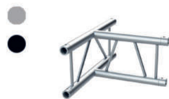
Esquina truss paralelo en T. 3 vías. 300mm. Tubo principal: 50x2mm. Tubo secundario: 16x2mm. Plateado o negro. SERIE F
