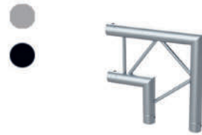
Esquina truss paralelo. 2 vías. 90°. 250mm. Tubo princ: 50x2mm. Tubo sec: 13x1,5mm. Plateado o negro. SERIE F
