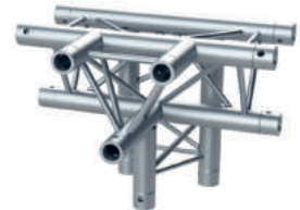
Esquina truss triangular en T. 4 vías. 250mm. Tubo principal 50x2mm. Tubo secundario 13x1,5mm. Plata o negro. SERIE F
