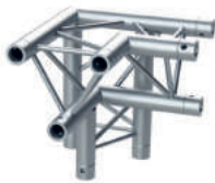
Esquina truss triangular. 3 vías. 90°. 250mm. Tubo princ: 50x2mm. Tubo sec: 13x1,5mm. Plata o negro. SERIE F
